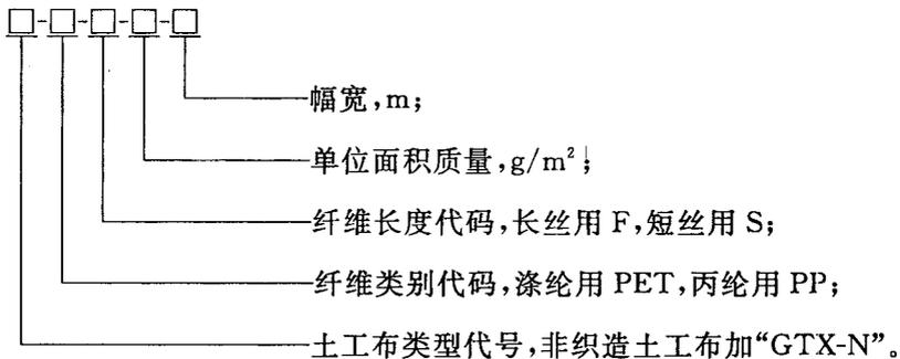
示例: 以丙纶为原料,采用长丝纤维生产的单位面积质量为 300 g/m<sup>2</sup>,幅宽为 4.5 m 的非织造土工布,表示为: GTX-N-PP-F-300-4.5。
